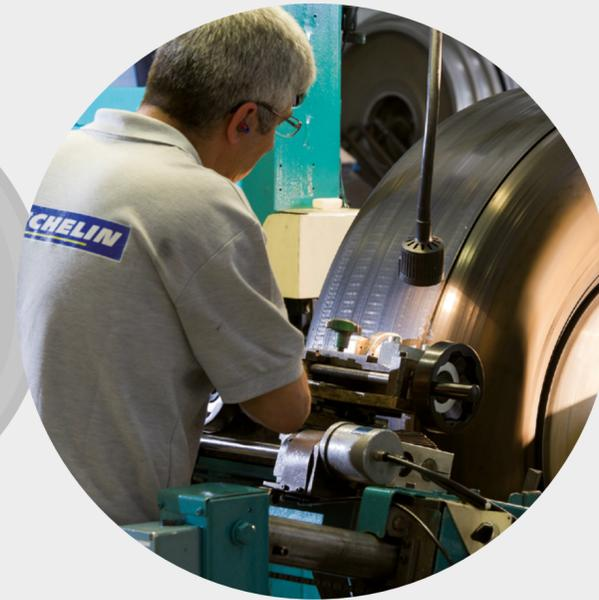
Cette pratique consiste à réutiliser la carcasse d'un pneu et à remplacer la bande de roulement usée par une neuve. Bien sûr, pour que le procédé fonctionne, les pneus MICHELIN sont conçus dès le départ dans le but d'être rechapés, avec une carcasse suffisamment robuste pour offrir plusieurs vies aux pneumatiques.
